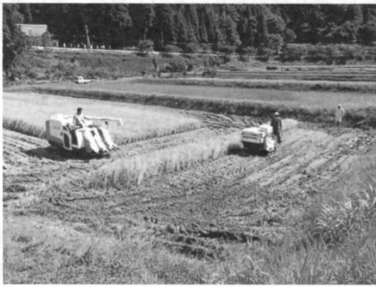
写真 10. 新式 (左) と旧式 (右) のコンバイン
